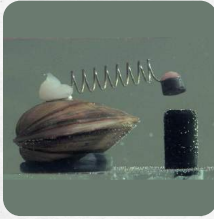
Polonya'nın başkenti Varşova'da su kalitesi istiridye ile izleniyor. Şayet suyun kalitesi bozulur ve tehlikeli hale gelirse istiridye kapanır, tetikleyiciler şehrin su kaynağını otomatik olarak kapatır.
